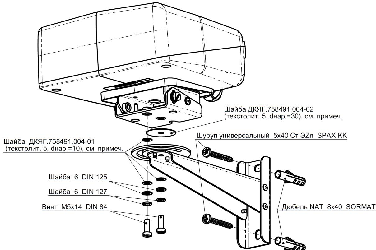
**Примечание:** для обеспечения плавности регулировки по горизонтали рекомендуется применять смазку Литол 24 или аналогичную
