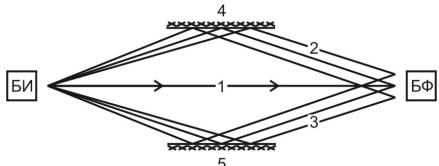
Похожий эффект может проявляться при наличии на улице дымки, измороси, легкого дождя, снега, особенно при установке БИ и БФ на дальностях более 75 м. В этом случае роль отражающих поверхностей **4** и **5** играют взвешенные в атмосфере частицы пыли, воды, снега.
