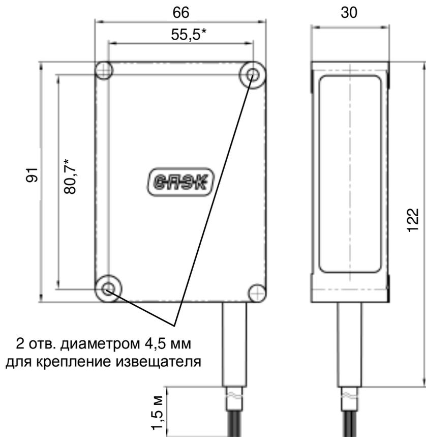
2 отв. диаметром 4,5 мм
