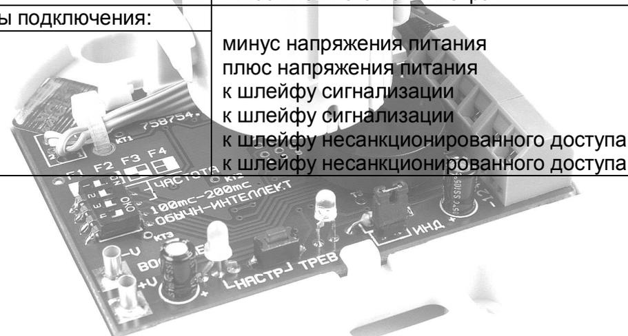
1.4.8 При включении режима «Настройка» (кнопка НАСТР в БФ) включается световой индикатор НАСТР, который индицирует уровень ИК сигнала на оптическом окне БФ, что значительно упрощает юстировку блоков извещателя и позволяет провести ее без применения внешнего вольтметра.
