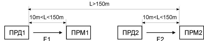
2.3.5 При проведении юстировки и настройки извещателей, установленных параллельно и/или последовательно друг другу, напряжение питания подается только на настраиваемый извещатель с отключением напряжения питания от остальных извещателей.
