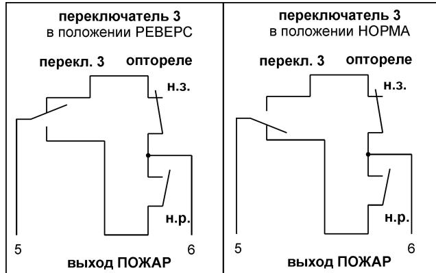
**ПРИМЕЧАНИЕ** - состояние контактов оптореле показано при отсутствии напряжения питания на ПРМ.
